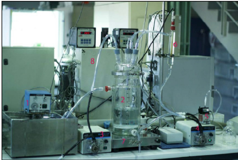
Figure 1 : Photo et schéma d'un réacteur batch « voie sèche » avec recirculation liquide
